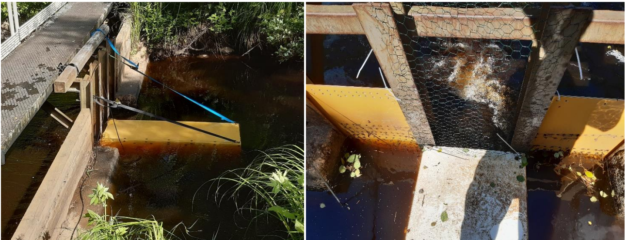
Kuva 3. Siikajoen Pöyryn pohjoisen luonnonmukaisen kalatien kameratunneli asennettuna.
